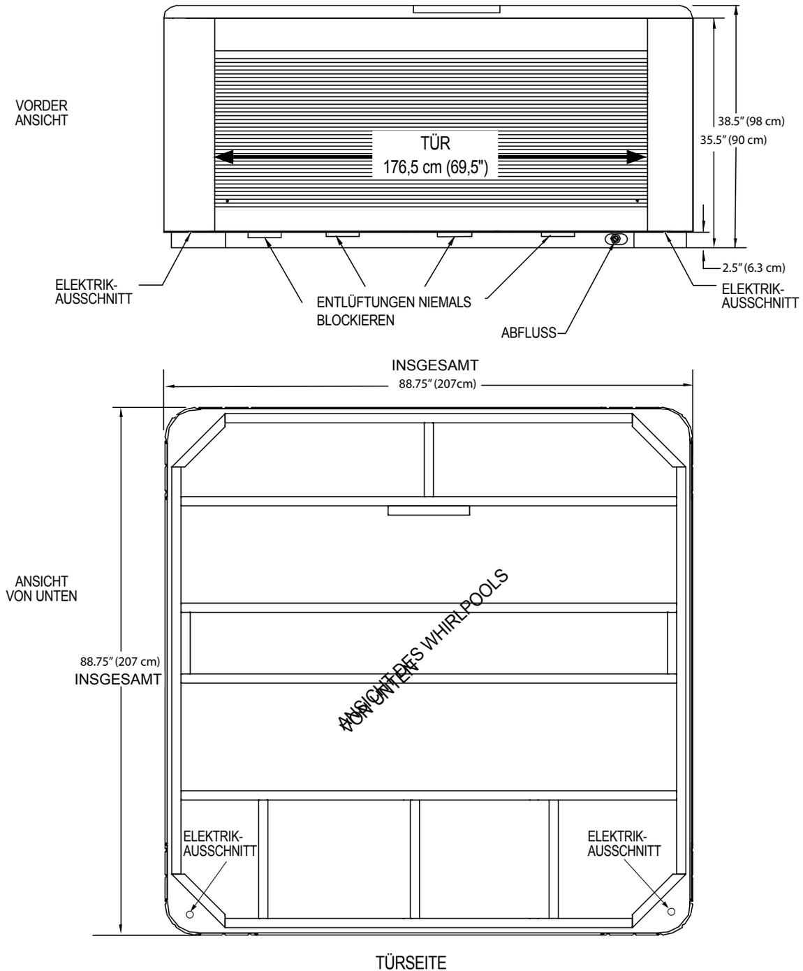
**HINWEIS:** Watkins Wellness empfiehlt, dass der **PALATINO** auf einem mindestens 10 cm (4") dicken Stahlbetonsockel oder einer stabilen Terrasse, die das in der Tabelle mit den technischen Daten des Whirlpools aufgeführte „Eigengewicht“ tragen kann, installiert wird.
