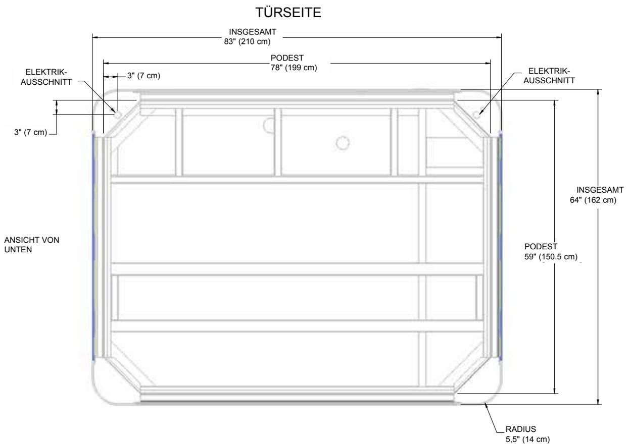
**HINWEIS:** Watkins Wellness empfiehlt, dass der **CELIO** auf einem mindestens 10 cm (4") dicken Stahlbetonsockel oder einer stabilen Terrasse, die das in der Tabelle mit den technischen Daten des Whirlpools aufgeführte „Eigengewicht“ tragen kann, installiert wird.
