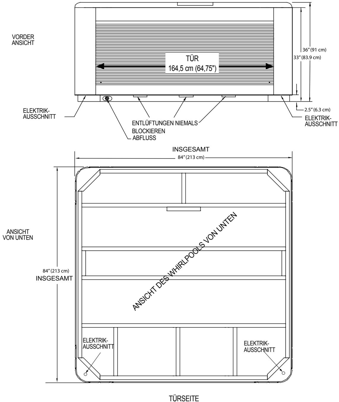
**HINWEIS:** Watkins Wellness empfiehlt, dass der **VANTO** auf einem mindestens 10 cm (4") dicken Stahlbetonsockel oder einer stabilen Terrasse, die das in der Tabelle mit den technischen Daten des Whirlpools aufgeführte „Eigengewicht“ tragen kann, installiert wird.
