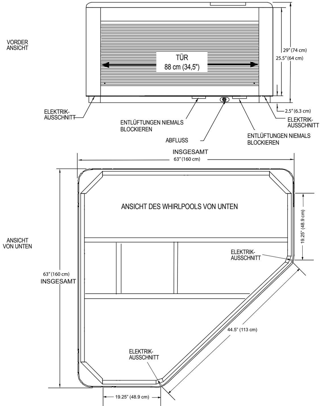
**HINWEIS:** Watkins Wellness empfiehlt, dass der **AVENTINE** auf einem mindestens 10 cm (4") dicken Stahlbetonsockel oder einer stabilen Terrasse, die das in der Tabelle mit den technischen Daten des Whirlpools aufgeführte „Eigengewicht“ tragen kann, installiert wird.
