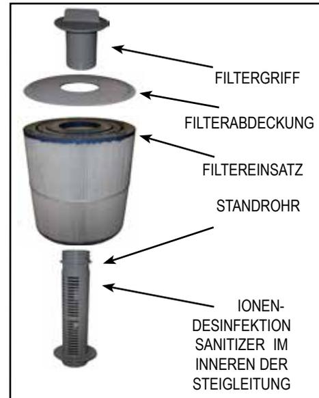
5. Reinigen Sie den Filter stets mit einem Filterentfetter wie z. B. einen Filterreiniger, um Mineralien- und Ölablagerungen zu entfernen. Lassen Sie den Filter einfach im Entfetter liegen (nach den Anweisungen auf der Verpackung). Danach legen Sie ihn auf eine saubere Oberfläche und spritzen ihn mit einem Gartenschlauch sauber. Es kann erforderlich sein, den Filter während der Reinigung mit dem Schlauch zu drehen, damit alle Schmutzpartikel aus den Falten entfernt werden.
