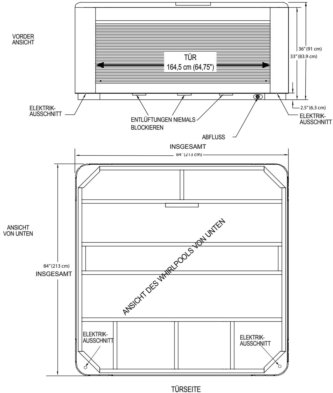
**HINWEIS:** Watkins Wellness empfiehlt, dass der **MARINO** auf einem mindestens 10 cm (4") dicken Stahlbetonsockel oder einer stabilen Terrasse, die das in der Tabelle mit den technischen Daten des Whirlpools aufgeführte „Eigengewicht“ tragen kann, installiert wird.
