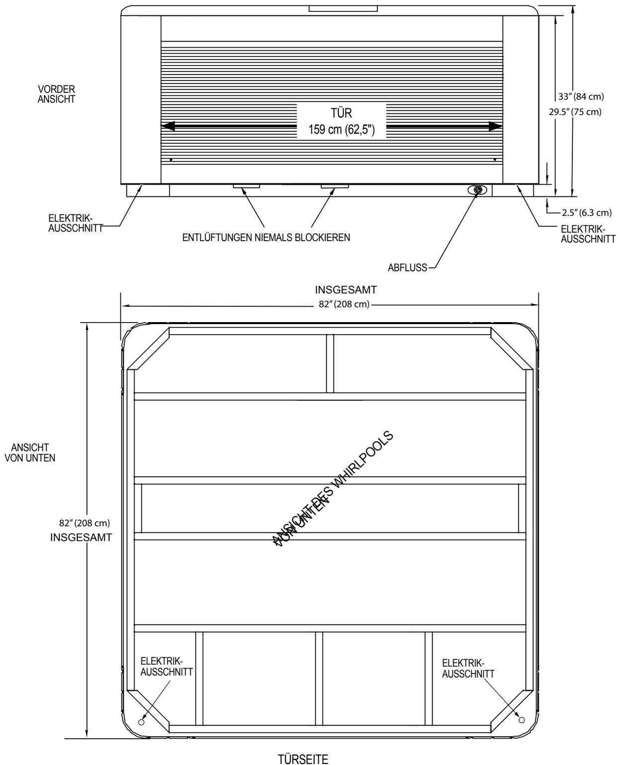
**HINWEIS:** Watkins Wellness empfiehlt, dass der **CAPITOLO** auf einem mindestens 10 cm (4") dicken Stahlbetonsockel oder einer stabilen Terrasse, die das in der Tabelle mit den technischen Daten des Whirlpools aufgeführte „Eigengewicht“ tragen kann, installiert wird.
